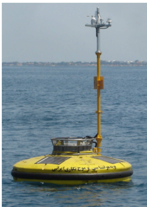
شکل ۷- نمونه بویه موج نگار ساخته شده که حسگر موج نگار در آن قرار می گیرد
